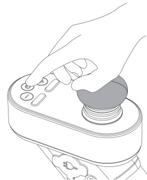
Emergencia: botón de encendido
