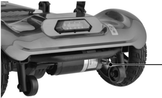
Palanca D / N: abajo para conducir en modo eléctrico, arriba para empujar en modo manual
