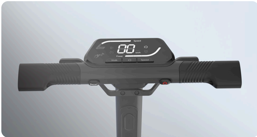
Manubrio del Q40: la pantalla muestra la velocidad en km/h y debajo tiene sus botones
