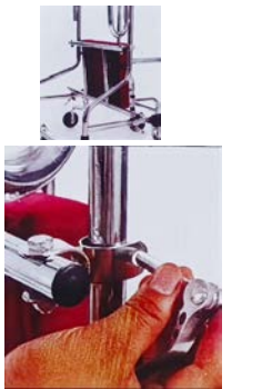
9.Instale la hebilla en la barra transversal del soporte inferior, luego coloque la placa de rodilla en la hebilla y luego use los tornillos para bloquearla y completarla.
